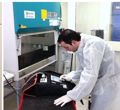
Dopo manutenzione ai filtri e attività di testing si eseguono le prove di sicurezza elettrica
